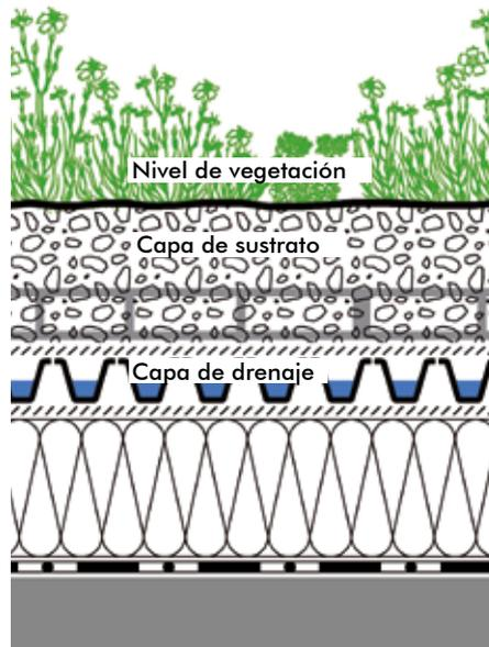
**Espesor de la estructura:** aprox. 13 cm
