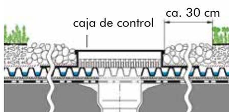
El desagüe de cubiertas planas generalmente se realiza con sumideros, cuyas cantidades y dimensiones tienen que averiguarse conforme a DIN EN 12056-3 o bien DIN 1986-100. Debido a las cajas de control los sumideros son accesibles en todo momento y pueden limpiarse, si hace falta.
