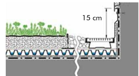
En fachadas muy ascendentes se recomienda incorporar adicionalmente canaletas de sistema o de fachadas, para poder conducir las lluvias torrenciales directamente a la capa de drenaje. En caso de menores cantidades de agua es suficiente el uso de una tira de grava.
