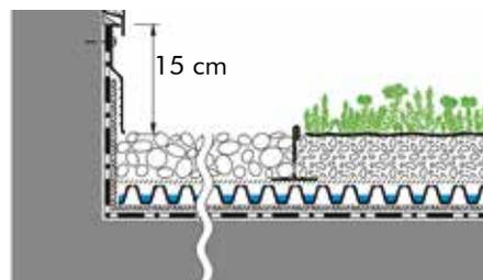
En elementos constructivos ascendentes, la altura del empalme debe encontrarse como mínimo 15 cm encima de la superficie de la capa acabada. El filtro drenante, la manta protectora y, eventualmente la lámina antirraíces se deben instalar igualmente debajo del perfil protector hasta el punto más alto
